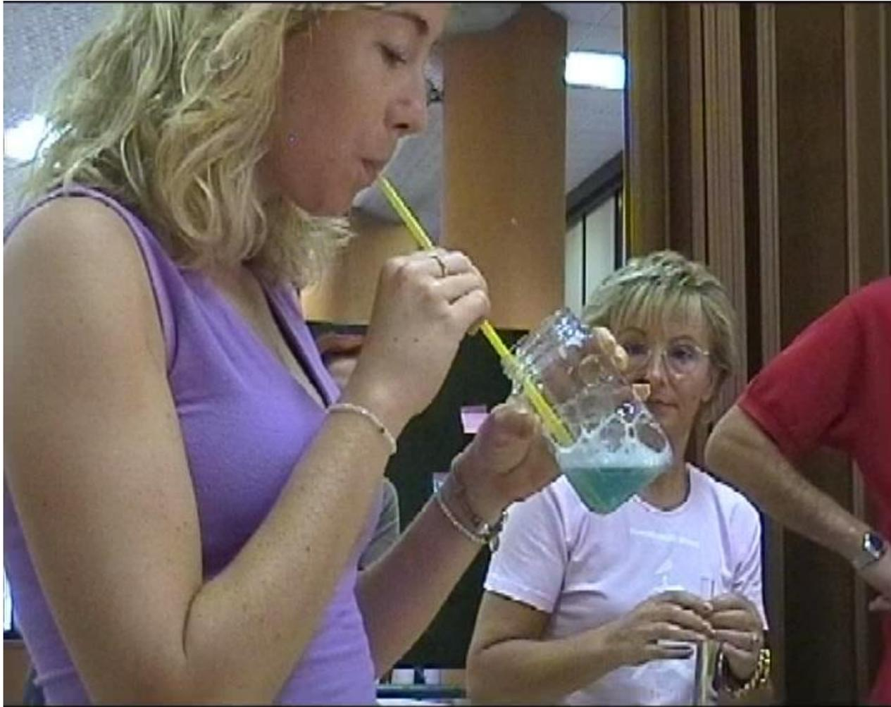
Nella terza provetta soffiare a lungo; il colore passerà al giallo rivelando la presenza dell'anidride carbonica nell'aria che vi abbiamo introdotto.
